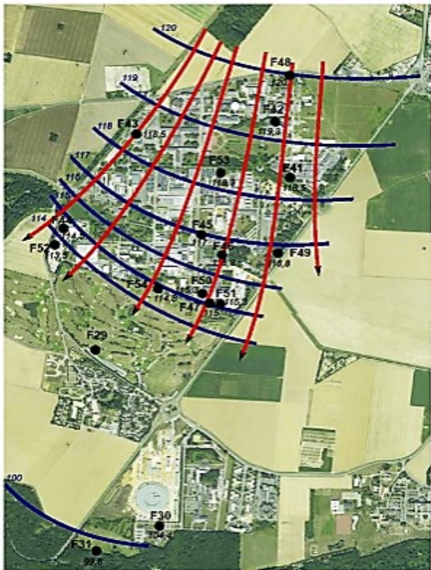
Courbes de niveau 2019 du toit de la nappe des sables de Fontainebleau au droit du centre CEA Saclay (en bleu) et lignes d'écoulement (en rouge)
