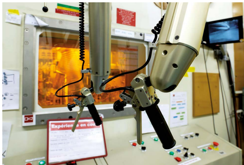
LECI - LIGNE K. Cellule dédiée à l'étude de la corrosion des matériaux irradiés. ©CEA/PF Grosjean
