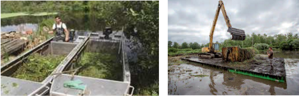
Figure 10 : Exemple de barge flottante utilisée pour l'arrachage (à gauche) ou d'une barge avec une pelle mécanique (à droite) ©CEN Centre-Val de Loire/F. Nimal
